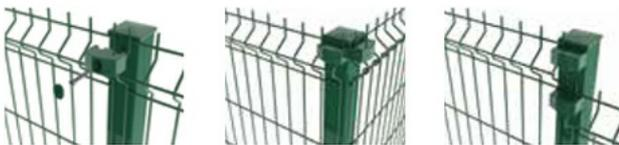
Les poteaux sont placés dans un mélange de béton sec (diamètre minimal 30 cm x 60 cm). Les poteaux sont placés tous les 2530 mm (+/- 5 mm) de milieu de poteau à milieu de poteau. Fixation frontale des panneaux sur les poteaux au moyen de fixations et de boulons de sécurité en acier inoxydable A2.
